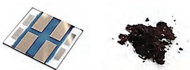
実際に作製した OPV 素子と合成した p 型半導体高分子
