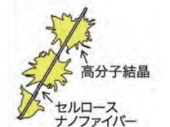
作製した試料の電子顕微鏡写真とモデル図。CNFの分散性が向上し、少量添加で複合体の力学性質が飛躍的に向上した。
